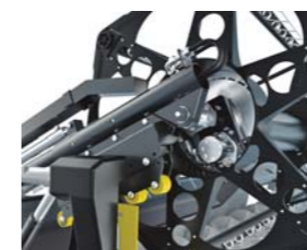
встроенный гидравлический привод барабана в основной трубе, ровное дно
